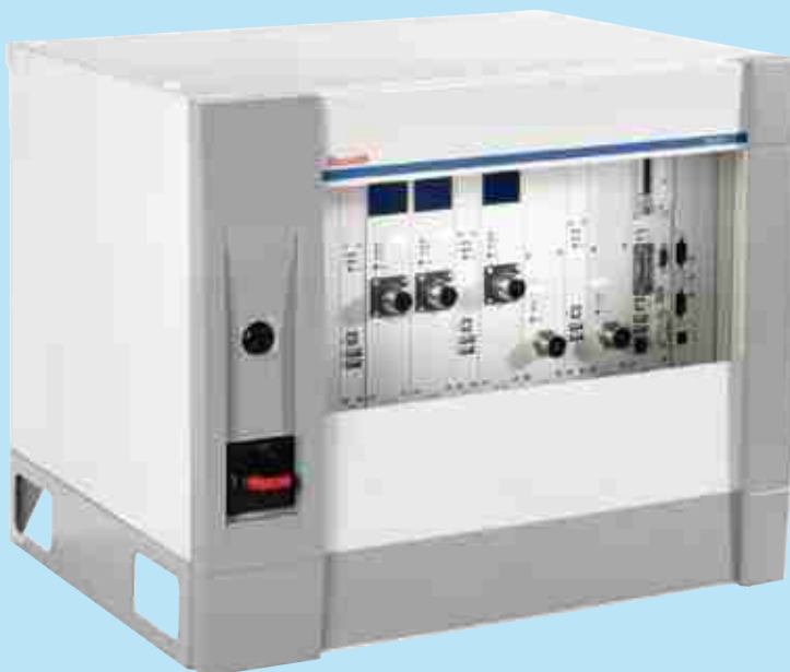
La caja de sistema SB356, protegida contra agua salpicada, está destinada al uso en ambientes industriales sin armario de distribución.
